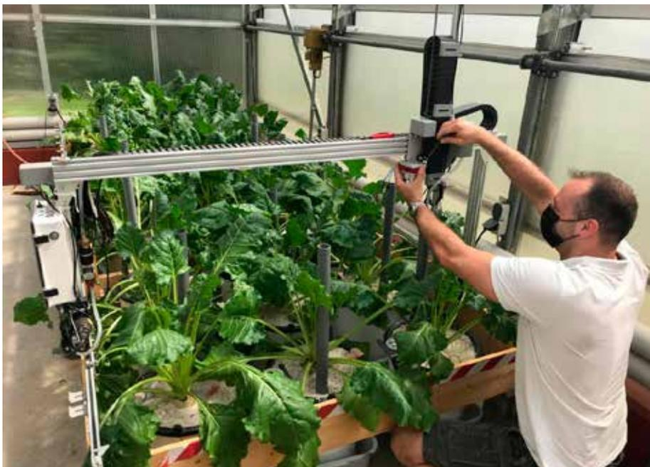
Ein HAWK Mitarbeiter montiert eine Multi-Spektralkamera an den Pflanzroboter
