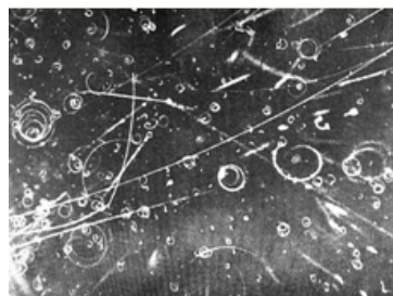
Abb. 3.1: Spuren kosmischer Teilchen in einer Nebelkammer [13]
