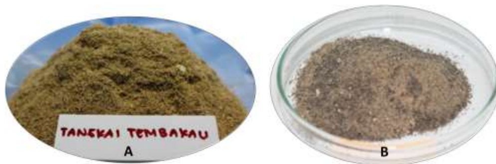
Gambar 1 Substrat tangkai tembakau. A : Biomassa tangkai tembakau 80 mesh, B : Xilan tangkai tembakau hasil ekstraksi.
